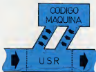
La función USR produce una interrupción temporal del control BASIC hacia una subrutina en código máquina.
